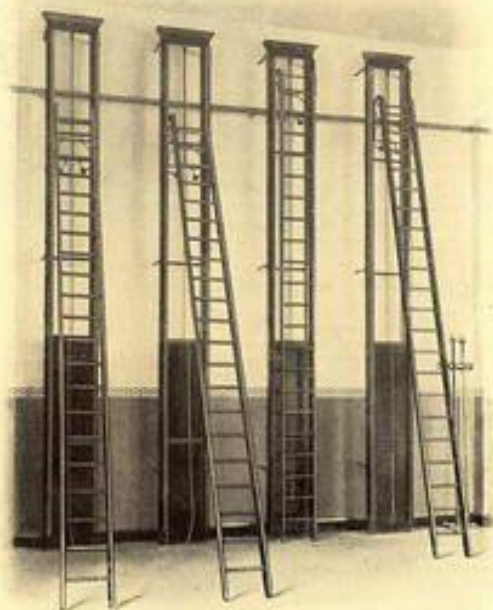
Moderne Rolleiter-Einrichtung für senkrechten, waagerechten und schrägen Gebrauch mit automatisch wirkender Sicherheits-Scherenbolzen-Verstellung
