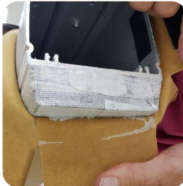
7. Nun ist der Bezug komplett entfernt und der neue Bezug kann montiert werden. Legen Sie dazu den neuen Bezug auf eine große (weiche, saubere) Arbeitsfläche. Achten Sie darauf, dass der Bezug komplett ausgebreitet ist. Positionieren Sie den unbezogenen Schwebebalkenkörper auf dem Bezug. Achten Sie darauf, dass das Balkenende an den Schnittmarkierungen der Lederklappen anliegt.
