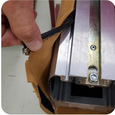
6. **ACHTUNG.** Unter dem Bezug ist doppelseitiges Klebeband auf den Schaumstoff geklebt. Dieses Klebeband muss auf dem Balken bleiben, wenn der Bezug entfernt wird.
