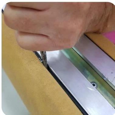
9. Die Lederklappen am Balkenende können nun mit Klettverschluss und doppelseitiges Klebeband am Balkenprofil fixiert werden. Bitte beachten Sie die gezeigte Reihenfolge in den Bildern
